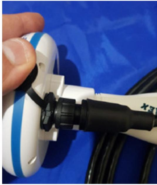
**OBS: Passe o cabo da antena de forma que caso ela se solte, ela fique suspensa ou longe do piso, para não se perder ou quebrar:**
