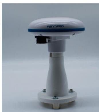
depois coloque no capô do seu trator com a chapa adesiva, caso não seja de metal,
