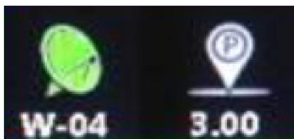
Visores do estado de recepção e nível de precisão do sinal do GPS
