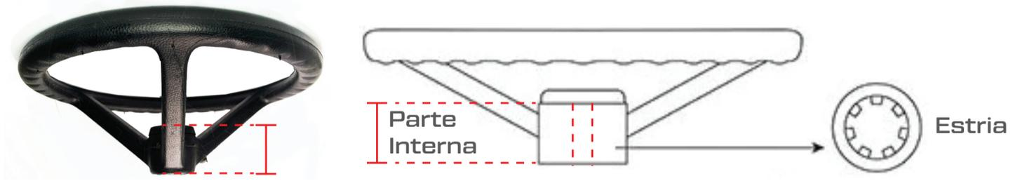
2. Com um paquímetro, medir o diâmetro das estrias do eixo e tirar foto nítida (medir sempre no início da estria).
