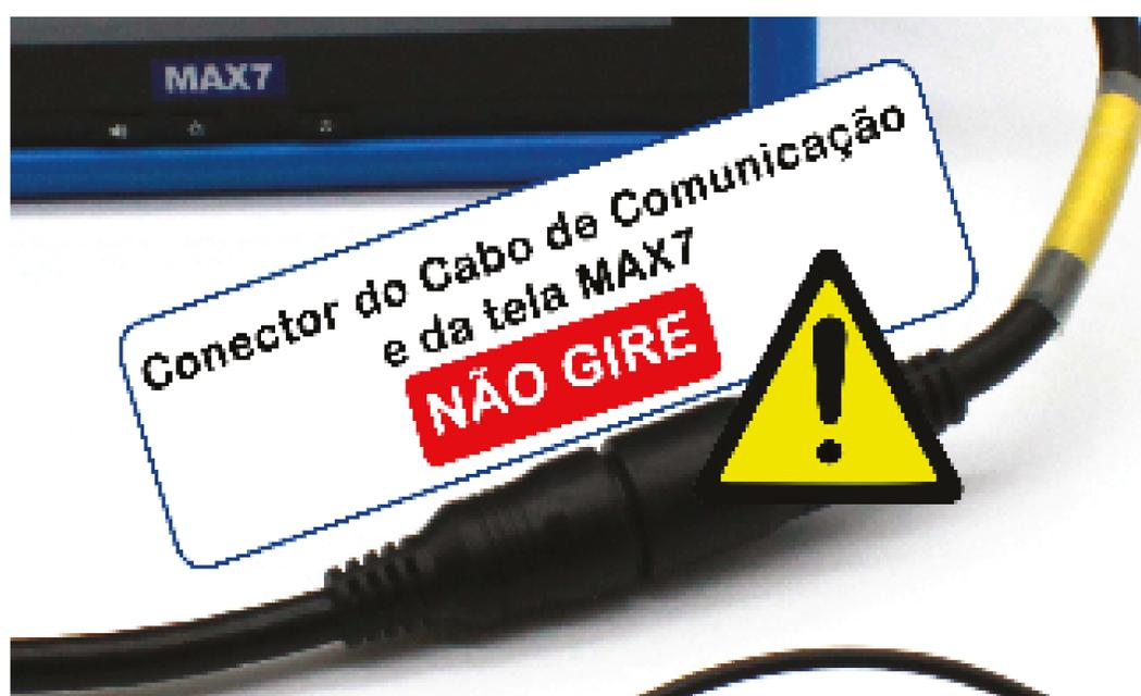
3. Conecte/Encaixe o conector do cabo de comunicação da tela. **NÃO GIRE.**
