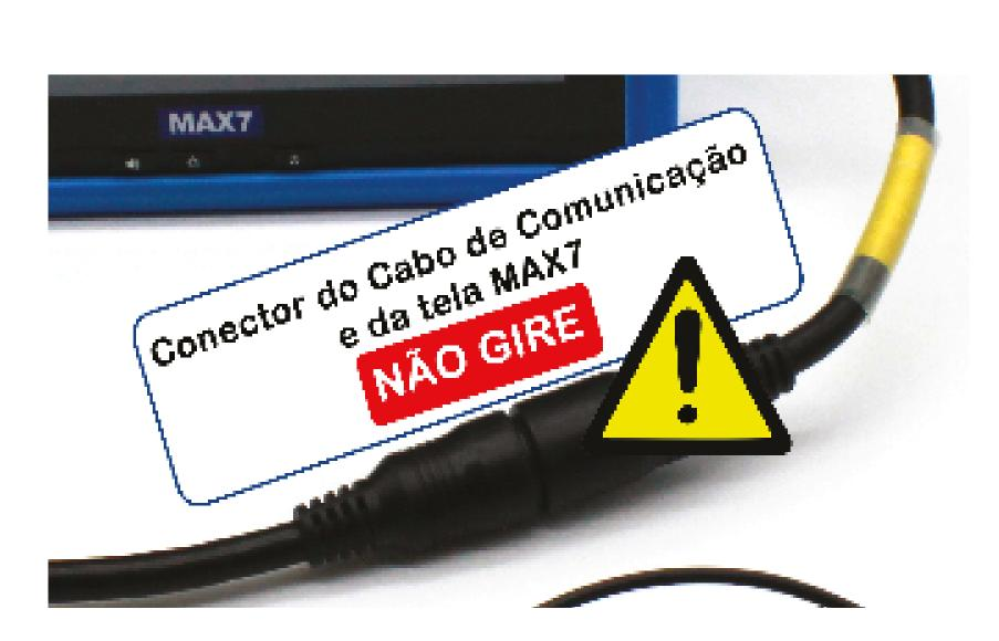
3. Conecte/Encaixe o conector do cabo de comunicação da tela. NÃO GIRE.
